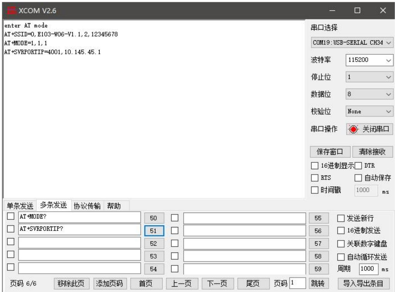
图 2-3-1 XCOM 查询连接参数
