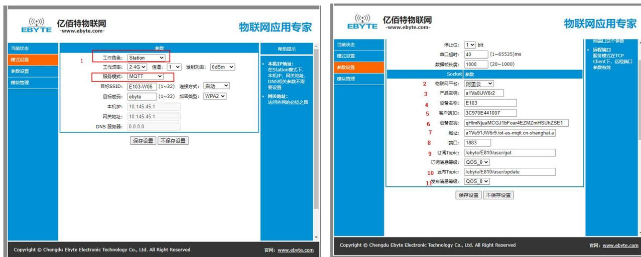
图 5-2-1 网页配置阿里云 MQTT 参数
