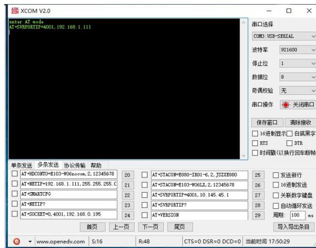
图 5-1-3 AT 查询服务器地址与端口
