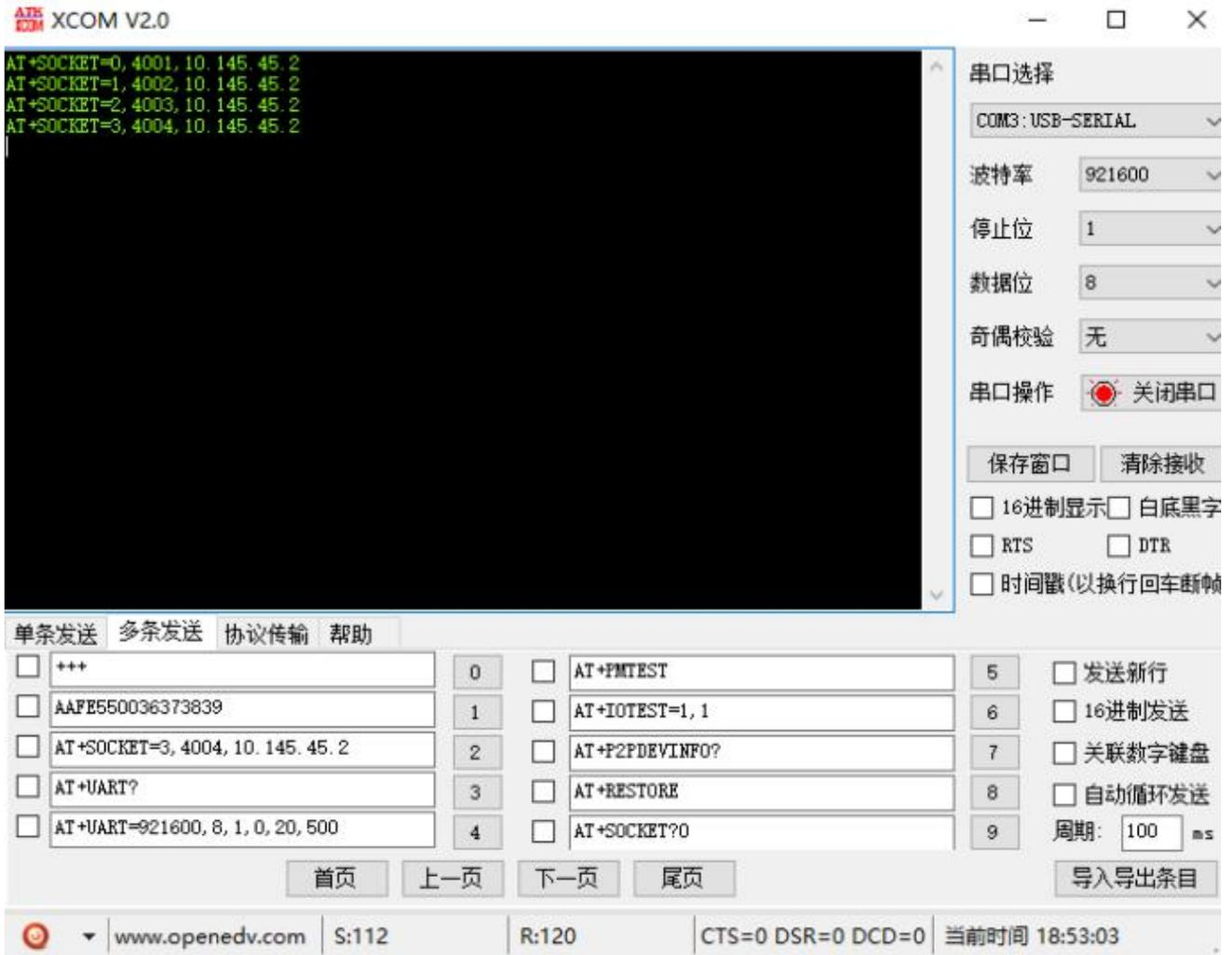
图 5-1-10 AT 配置 UDP 连接 SOCKET
